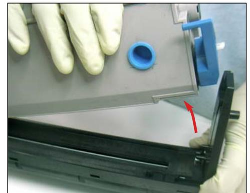
3. Levantar el deposito de la unidad de cilindro, a partir del lado del mano azul, como se indica.
