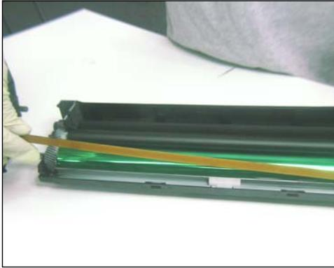
12. Sacar la lámpara de borrado del cilindro como se indica.
