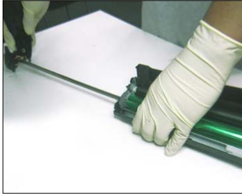
13. Deslizar completamente la tapa lateral con el eje.
