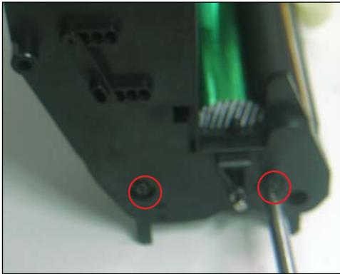
9. Sacar los dos tornillos que sujetan la tapa lateral del lado sin engranajes en su lugar.
