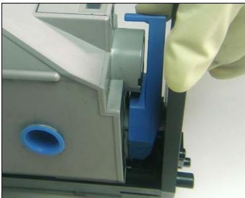
1. Liberar el deposito de toner de la unidad de cilindro girando el mango azul hacia abajo de su posición "locked," como se muestra.
