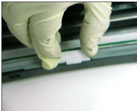
19. Sacar el soporte de la lámpara de borrado tirando hacia afuera.
